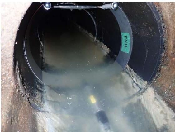
圧力チップによる計測状況
